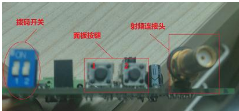
图 2 采集器前面板接口图
